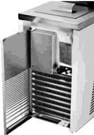
L'agrégat de refroidissement du système SmartCool ne nécessite pratiquement aucune maintenance. Pour que toute la puissance du refroidissement soit disponible, l'échangeur de chaleur (condenseur) doit être nettoyé tous les mois ou selon un intervalle plus long en fonction de la durée de fonctionnement et de la poussière provenant de l'environnement de l'appareil. Pour cela, ouvrir la grille avant et épousseter le condenseur ; envoyer si nécessaire de l'air comprimé.
